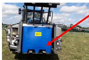
Le caisson avant permet de charger une cuve d'acide de 1000 litres de type IBC. Chargé de 1,8 tonnes d'acide concentré, c'est alors une masse de 3 tonnes qui pèse sur le relevage avant du tracteur.
