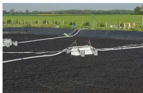
Figure 4: Photographie du dispositif de mesure des émissions gazeuses positionné sur une lagune de stockage des digestats.
