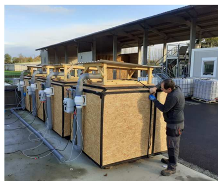
Figure 1: Pilotes de stockage de 1m 3 utilisés pour représenter les stockages en lagune à une échelle expérimentale (cuve isolée pour représenter l'effet du sol et équipée d'un dispositif de suivi des émissions vers l'air (chambre dynamique)).
