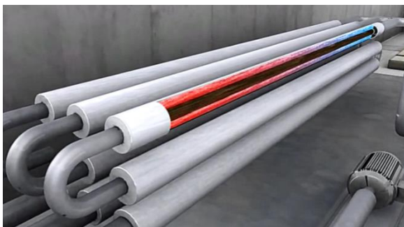
Exemple d'hygiénisation en continu par échangeur tubulaire
