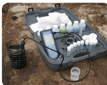
Figure 6 : Analyseur portable multiparamètres (T, pH, EC)
