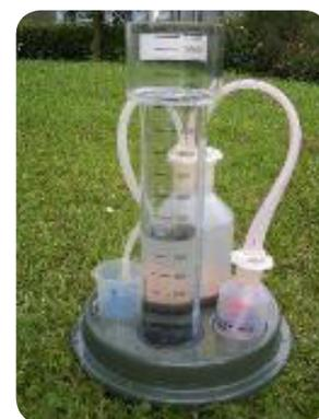
Figure 7 : Analyseur du TAC et de la teneur en  $\text{NH}_4^+$  (BiogasPro©)
