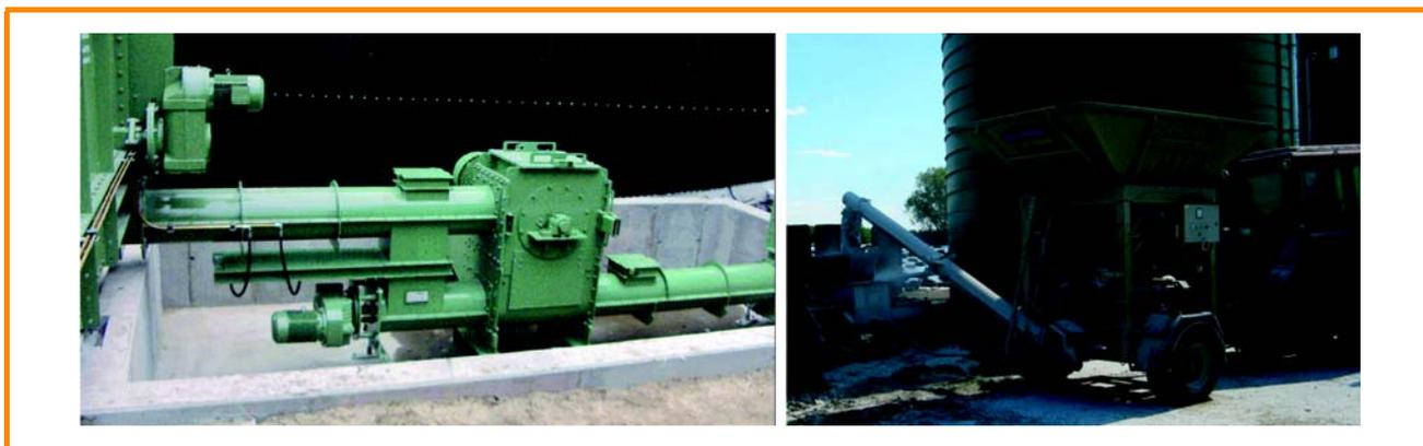
Figure 3.7 : Broyeur à marteaux et à rouleaux pour le broyage des substrats solides [Huning Maschinenbau GmbH, DBFZ]
