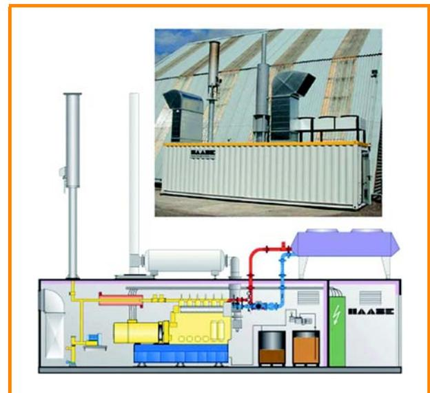
Figure 6.5 : Unité de cogénération, module autonome compact avec torche [Haase Energietechnik AG]
