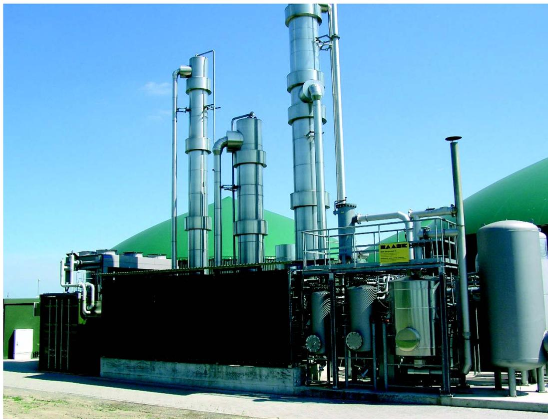
Figure 6.3 : Centrale de traitement du biogaz (épuration Genosorb) à Ronnenberg [Urban, Fraunhofer UMSICHT]
