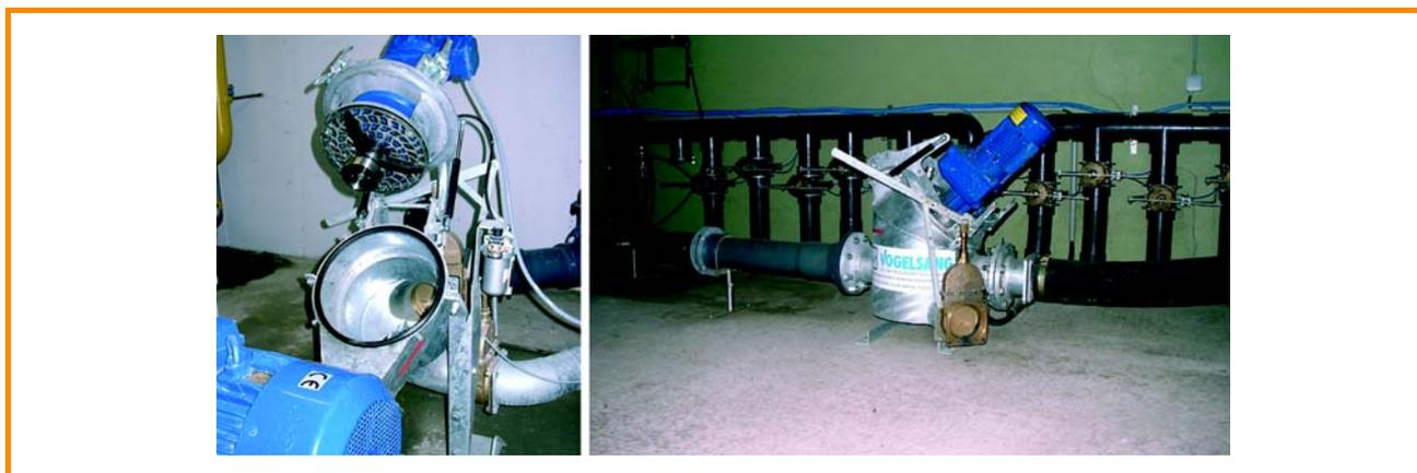
Figure 3.8 : Broyage du substrat à l'intérieur de la canalisation (dispositif de broyage à plaque perforée) [Hugo Vogelsang Maschinenbau GmbH]
