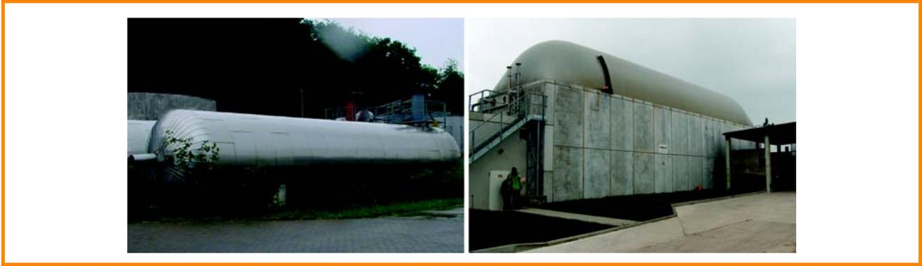
Figure 3.25 : Réacteurs piston ; exemples concrets, cylindrique (à gauche), section rectangulaire avec réservoir de gaz au-dessus (à droite)
