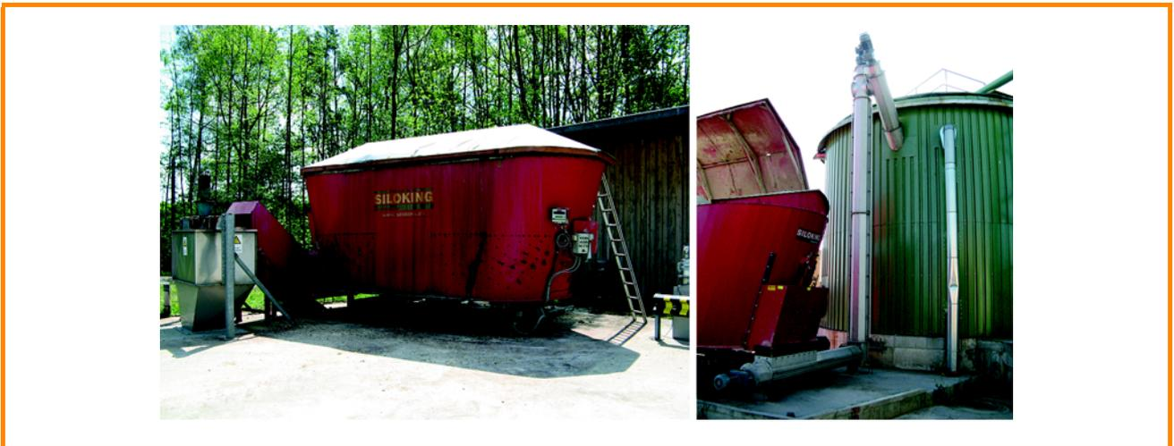
Figure 3.19 : Introduction de substrats solides dans le digesteur au moyen de vis sans fin [DBFZ]
