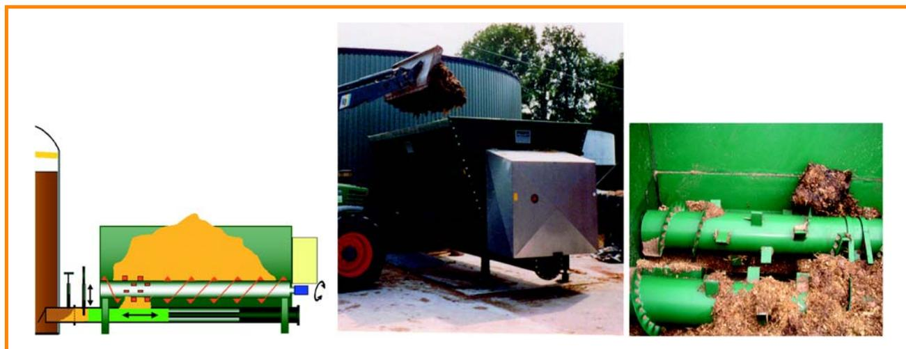
Figure 3.18 : Introduction de substrats solides dans le digesteur au moyen d'un système à piston [PlanET Biogastechnik GmbH]
