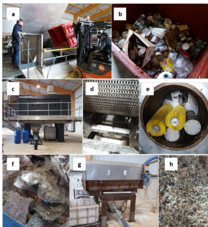
Figure 35 : (a) Chargement de la trémie (b) refus issu du tri manuel (c) déconditionneur Flexiboot (d) grille de séparation du Flexiboot et bac de collecte de la pulpe (e) mécanisme de compression et séparation des biodéchets (f) refus grossier issu du déconditionneur (g) post-traitement avec prototype Flexipure (h) refus fin issu du post-traitement. – Site n°5
