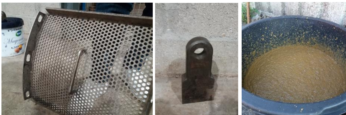
Figure 42 : (gauche) Pièce de rechange du crible (milieu) Modèle de marteau (droite) Pulpe organique – Site n°6
