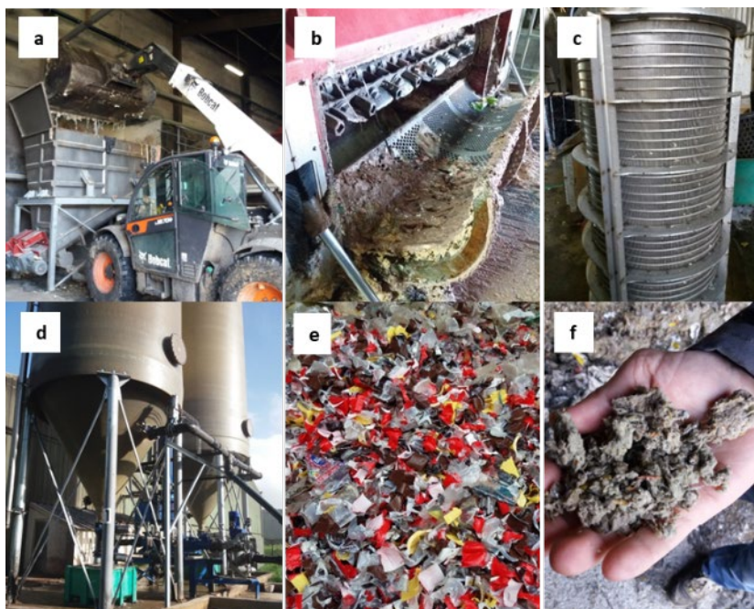
Figure 28 - (a) Chargement de la trémie (b) grille de séparation du déconditionneur (c) grille de recharge du post-traitement (d) tours de décantation (e) refus du déconditionneur (f) refus du post-traitement.
