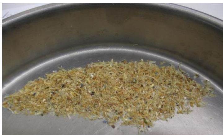
Figure 9 : Exemple d'éléments fins passant à travers une maille de 2 mm
