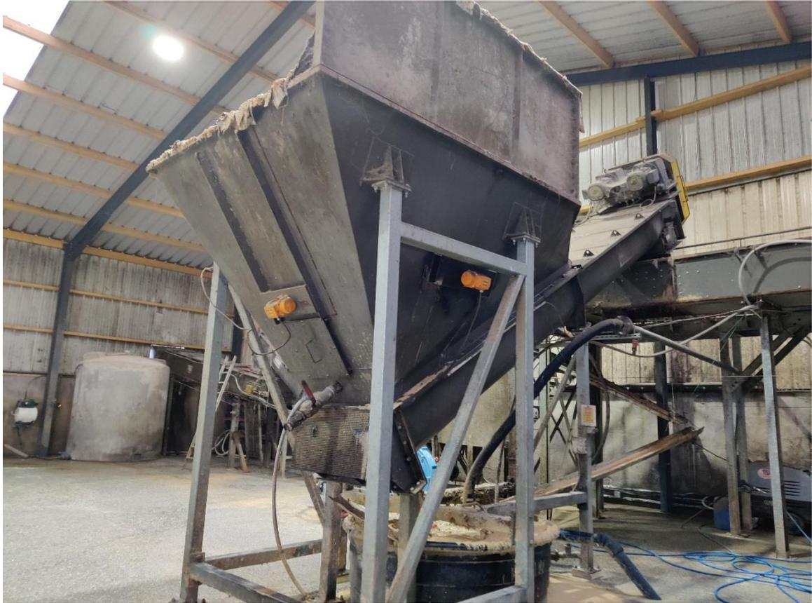
**Trémie d'incorporation avec convoyeur à double vis**
