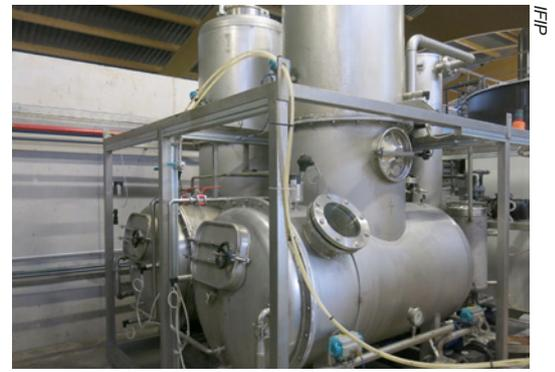
Evapo-concentrateur K-Révert en fonctionnement sur du digestat
