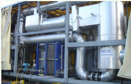
Procédé de stripping suivi d'une combustion catalytique de l'azote (Smelox) sur chassis mobile pour un traitement en prestation de service
